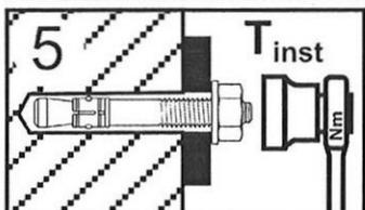
Montagemoment  $T_{inst}$  mit Drehmomentschlüssel aufbringen.
