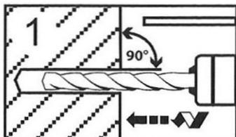
Bohrloch senkrecht zur Oberfläche des Verankerungsgrunds erstellen.
