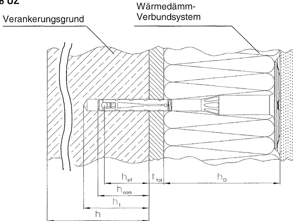
fischer Schraubdübel TERMOZ 8 U, TERMOZ 8 UZ und WS 8 L
