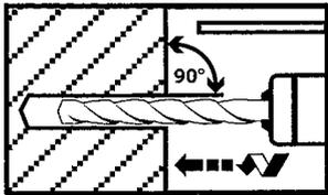
Bohrloch senkrecht zur Oberfläche des Verankerungsgrunds erstellen.
