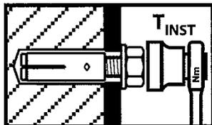
Montagemoment  $T_{inst}$  mit Drehmomentschlüssel aufbringen.
