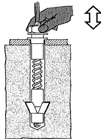
Durch Auf- und Abbewegen des Ankers ist zu prüfen, ob die Spreizsegmente zuverlässig in die Hinterschneidung eingerastet sind.
