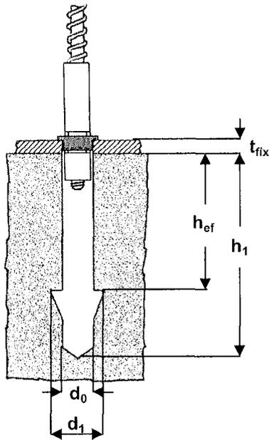
Der Liebig Ultraplus™ Hinterschneidanker wird durch das Anbauteil in das Bohrloch gesetzt. Der Kunststoffring, der die Spreizsegmente zusammenhält, wird abgestreift und gibt die Spreizsegmente frei. Beim Erreichen der Hinterschneidung öffnen sich diese durch den Federdruck automatisch und rasten spür- und hörbar ein.
