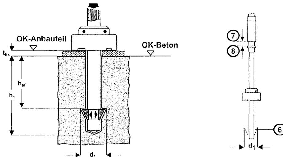
Durch Druck auf das Hinterschneidergerät öffnen sich die Diamant-Schneidelemente (6). Bei Verwendung des Handhinterschneiders den Hebel nach unten drücken. Der Hinterschneiddurchmesser  $d_1$  ist erreicht, wenn Justierhülse (7) und Stelling (8) bis auf Kontakt zusammengefahren sind.
