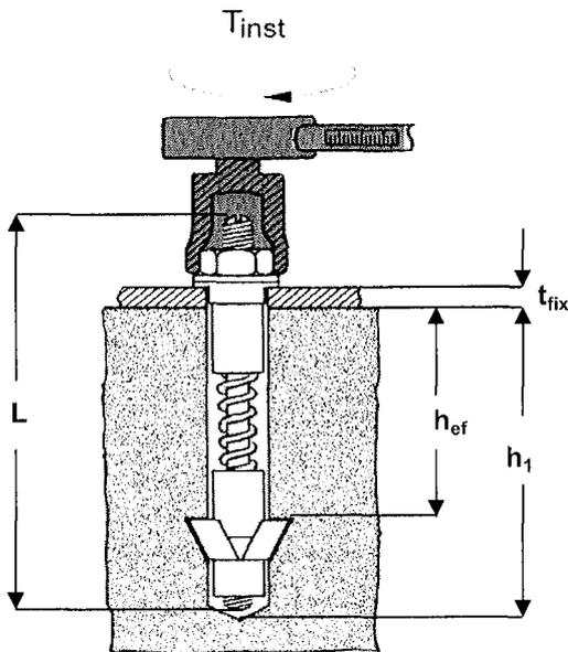
Montagedrehmoment  $T_{inst}$  mittels kalibriertem Drehmomentschlüssel aufbringen.
