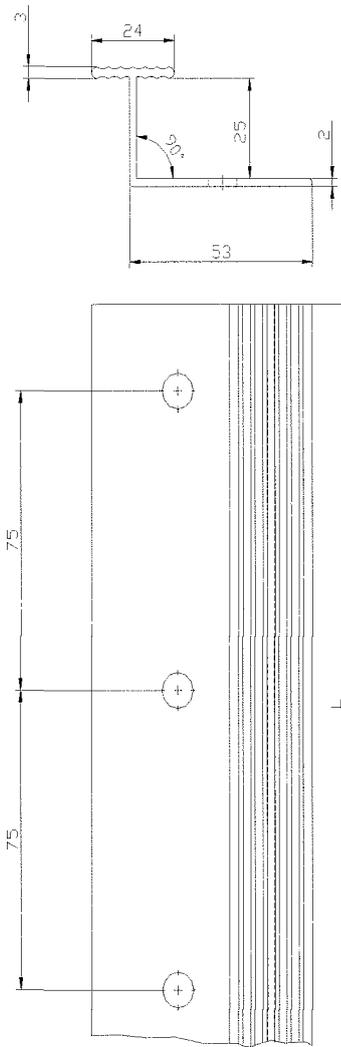
**Vertikales Verbindungsprofil "SAKRET Verbindungsschiene" (Abmessungen in Millimetern)**
