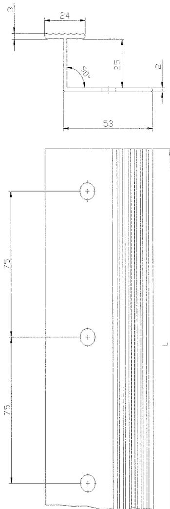
**Vertikales Verbindungsprofil "SAKRET Verbindungsschiene" (Abmessungen in Millimetern)**
