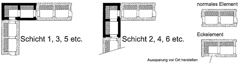
Schichtaufbau in der Wandecke – Typ DSi 30/20Lap
