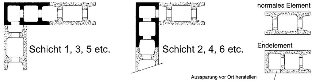
Schichtaufbau in der Wandecke – Typ DS 25/12, DM 25/16 und DSs 25/12
