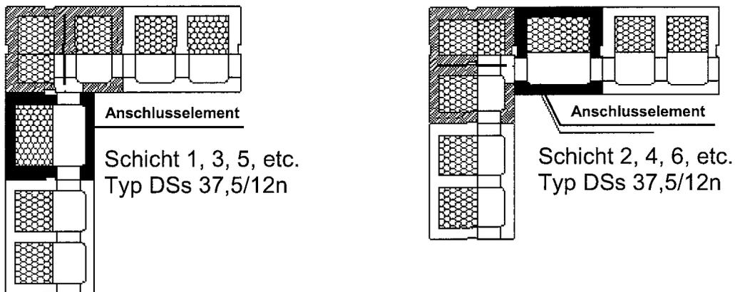
Wanddecken mit DSs 30/12 werden analog ausgeführt
