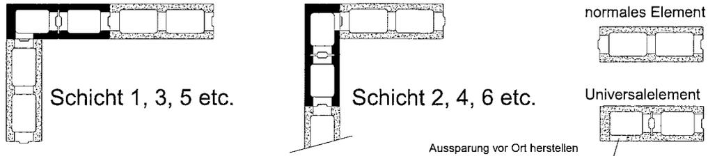
Schichtaufbau in der Wandecke – Typ DMi 20/13Lap
