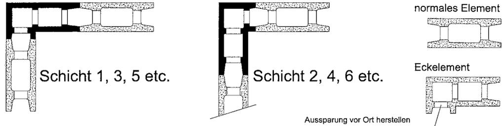
Schichtaufbau in der Wandecke – Typ DMi 25/18Lap
