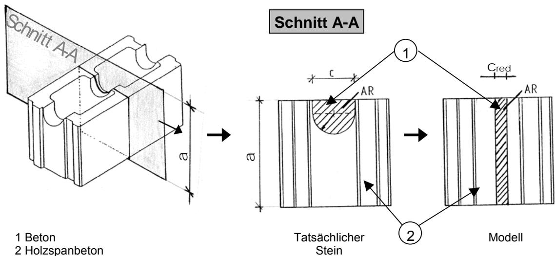
Im Falle von Schalungs-/Mantelsteinen mit eingepassten Wärmedämmstoffen ist mindestens die zweite Methode anzuwenden.
