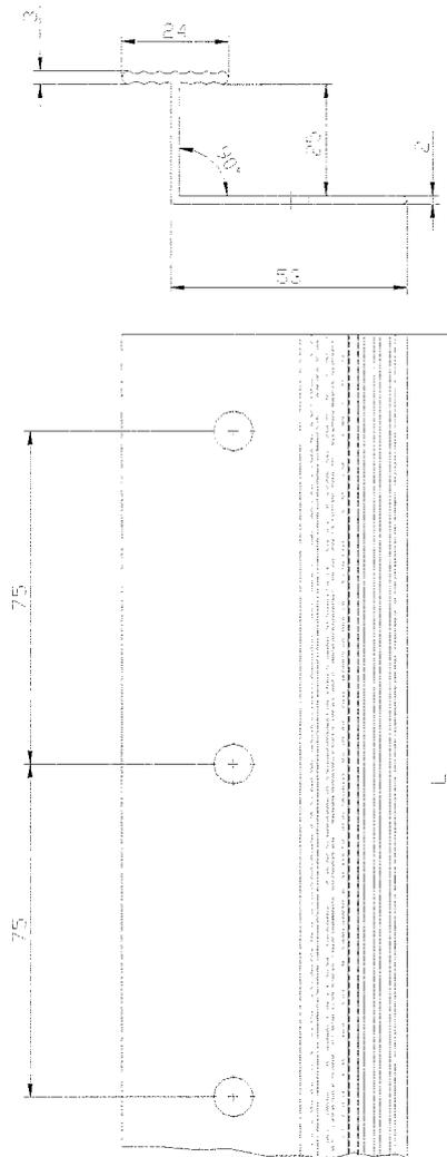
**Vertikales Verbindungsprofil – "Grigolin Verbindungsschiene" (Maße in mm)**
