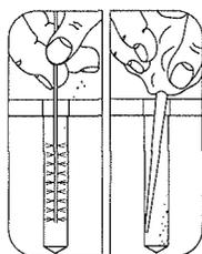
Reinigung des Bohrlochs von Bohrmehl
