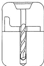
Bohrloch senkrecht zur Oberfläche des Verankerungsgrunds mit Hammerbohrer oder Pressluftbohrer erstellen
