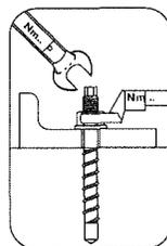
Unterlegscheibe und Sechskantmutter montieren. Das maximale Anzugsdrehmoment der Mutter darf nicht überschritten werden. Die Mutter muss mit einem kalibrierten Drehmomentschlüssel festgezogen werden
