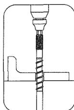
Schraubanker mit Tangentialschlagschrauber (Werkzeugaufnahme < 3/4") **oder** manuell einschrauben. Einbau so, dass die Länge des Dübels im Beton mindestens dem Wert  $h_{nom}$  nach Anhang 2, Tabelle 2 entspricht.
