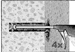
Bohrlöcher ab Durchmesser 20 mm oder tiefer 240 mm **müssen** mit min. 6 bar ölfreier Druckluft ausgeblasen werden.
