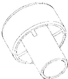
**Verfüllstutzen für Überkopf- oder Horizontalmontage**
