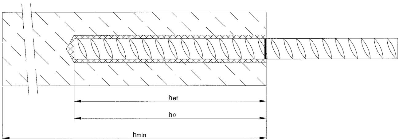
BTI Injektionssystem UVT-SF Plus in Beton
