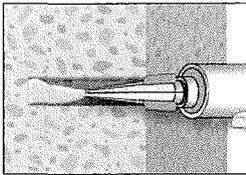
**6** Gereinigtes Bohrloch vom Bohrlochgrund her ca. zu 2/3 mit Verbundmörtel befüllen. Langsames Zurückziehen des Statikmischers aus dem Bohrloch verhindert die Bildung von Luftschlüssen. Für Setztiefen größer 190 mm passende Mischerverlängerung verwenden. Für die Horizontal- oder Überkopfmontage von Ankern > Ø 20 mm sind Verfüllstützen gemäß Anhang 8 zu verwenden. Die temperaturrelevanten Verarbeitungszeiten (Tabelle 4) sind zu beachten.
