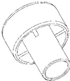
**Verfüllstutzen für Überkopf- oder Horizontalmontage**
