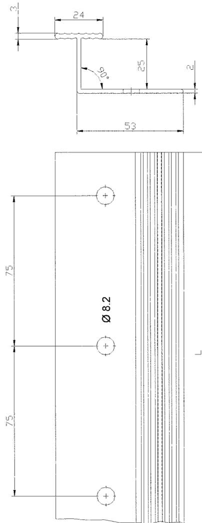
**Vertikales Verbindungsprofil – "Verbindungsleiste PVC" (Abmessungen in Millimetern)**
