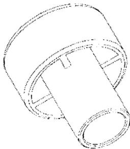
**Verfüllstutzen für Überkopf- oder Horizontalmontage**
