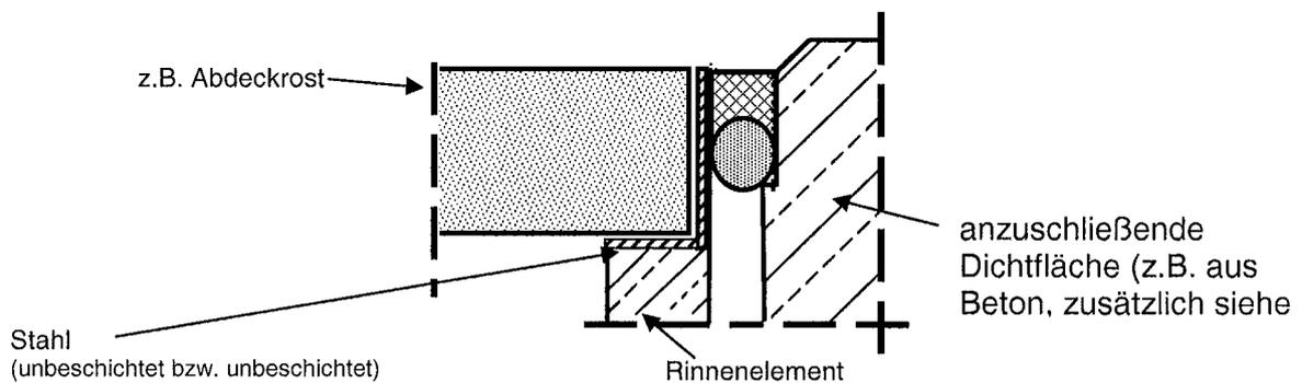
1) KTL-beschichteter Stahl nur zulässig mit einer kathodischen Tauchlackierung auf Basis von aminiertem, wasserunlöslichem Epoxidharz auf Bisphenol A.
