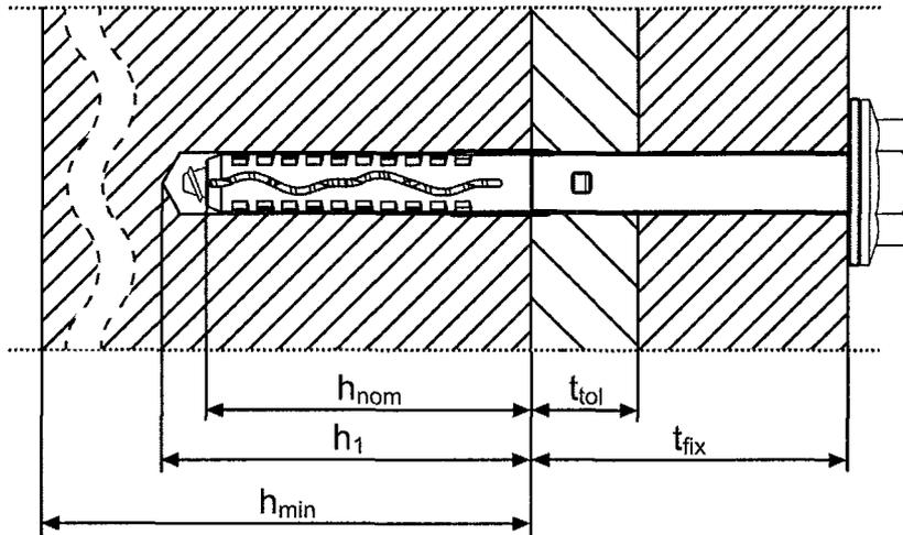
Anwendung in Loch- oder Hohlsteinmauerwerk
