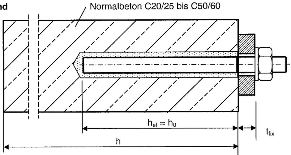
Nutzungskategorie: - Einbau im trockenen oder nassen Beton, nicht in wassergefüllte Bohrlöcher
