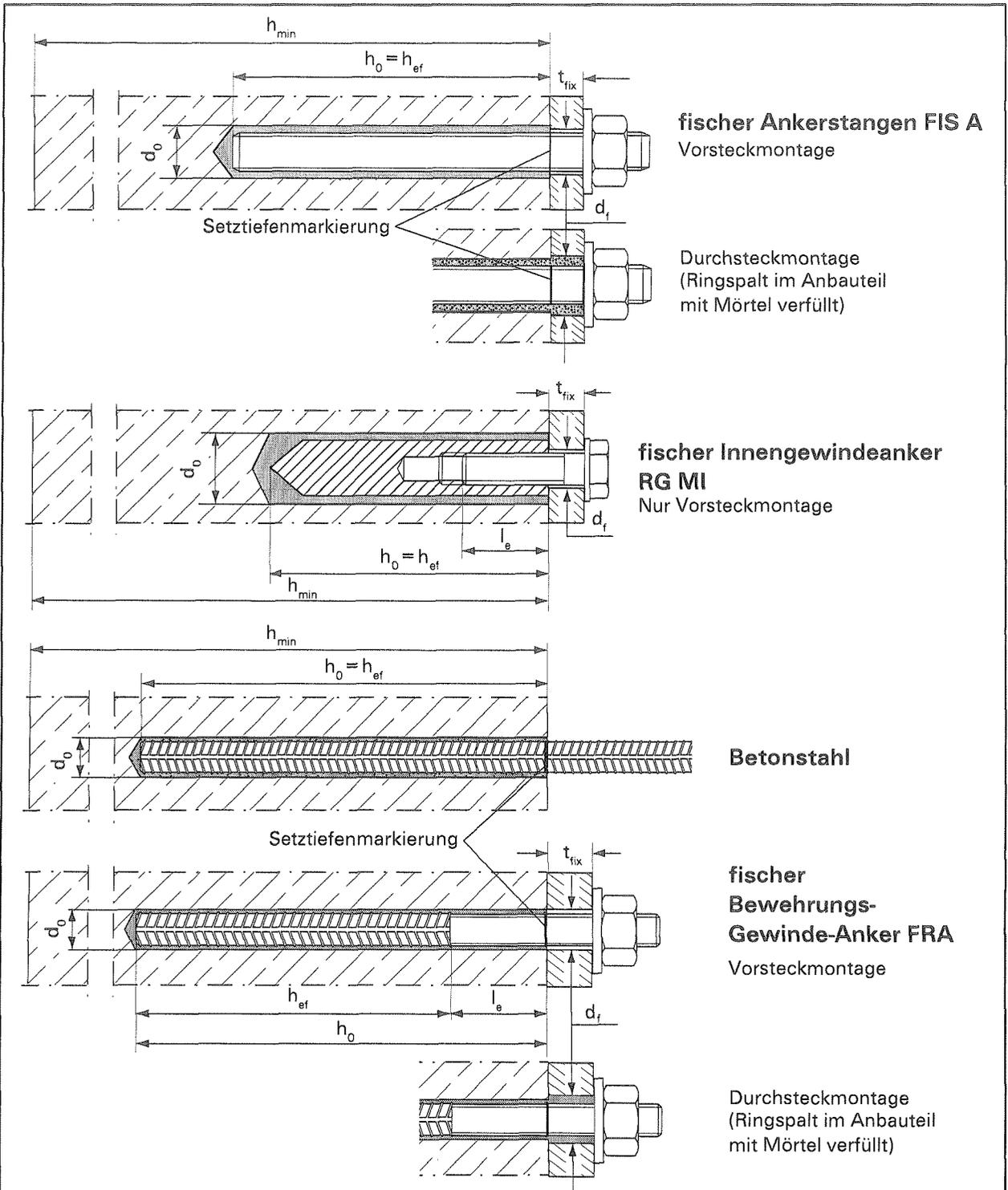
**Verwendung in trockenem und nassem Beton**
