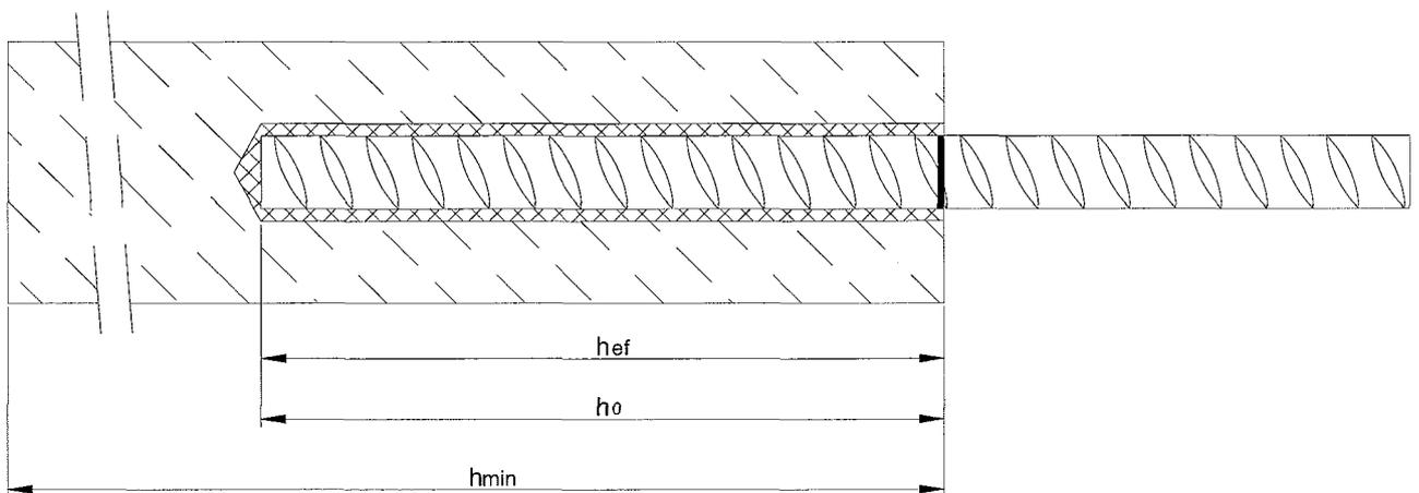
VJ Technology Injektionssystem HPE 385 in Beton
