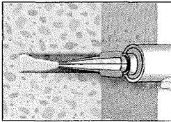
6. Gereinigtes Bohrloch vom Bohrlochgrund her ca. zu 2/3 mit Verbundmörtel befüllen. Langsames Zurückziehen des Statikmischers aus dem Bohrloch verhindert die Bildung von Lufteinschlüssen. Für Setztiefen größer 190 mm passende Mischerverlängerung verwenden. Für die Horizontal- oder Überkopfmontage von Ankern > Ø 20 mm sind Verfüllstützen gemäß Anhang 8 zu verwenden. Die temperaturrelevanten Verarbeitungszeiten (Tabelle 4) sind zu beachten.
