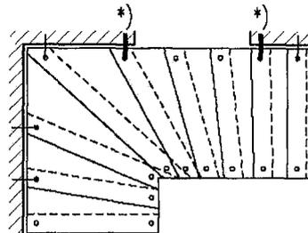
Tragbolzenverbindung Typ III    Tragbolzenverbindung Typ IV
