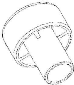
**Verfüllstutzen für Überkopf- oder Horizontalmontage**
