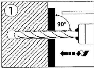
Bohrloch senkrecht zur Oberfläche des Verankerungsgrunds erstellen.
