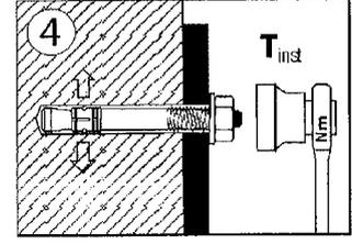
Montagemoment  $T_{inst}$  mit Drehmomentschlüssel aufbringen.
