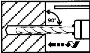
Bohrloch senkrecht zur Oberfläche des Verankerungsgrunds erstellen.
