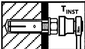
Montagemoment  $T_{inst}$  mit Drehmomentschlüssel aufbringen.
