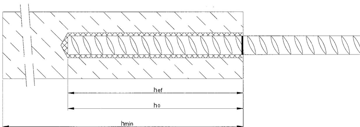
TP Injektionssystem VSF für Beton
