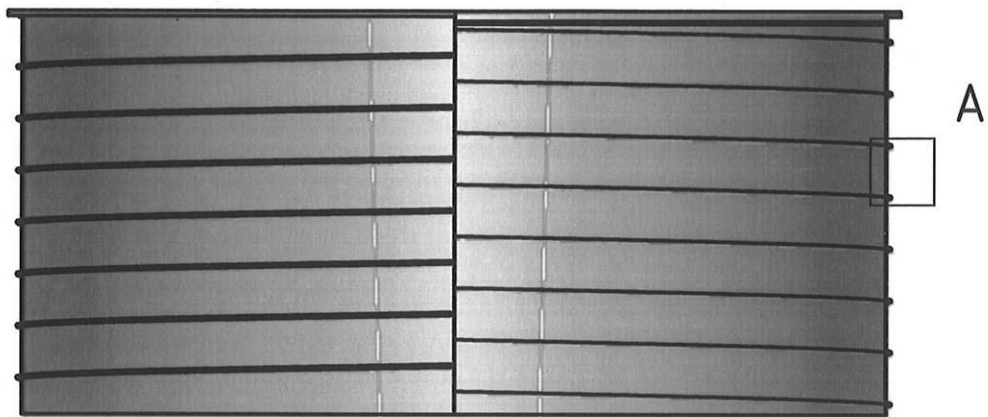
Spiralgefalteter Behälter nach LIPP - System Ansicht/ Schnitt
