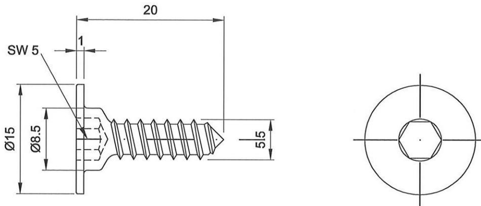
Sonderholzschraube mit TX-Antrieb St 4,5x35
