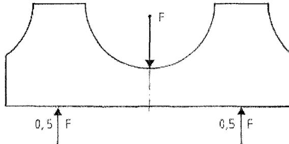
**Bild 2:** Belastungsanordnung Zugversuch
