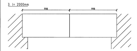
Emsländer Baustoffwerke GmbH & Co KG Rakener Str. 18 49733 Haren Fertigteilstürze aus Kalksandelementen Anlage 4 Deutschee Institut für Bantechnik zur allg. bauaufsichtlichen Zulassung Nr. Z-17.1-621 vom 9. Juli 2010
