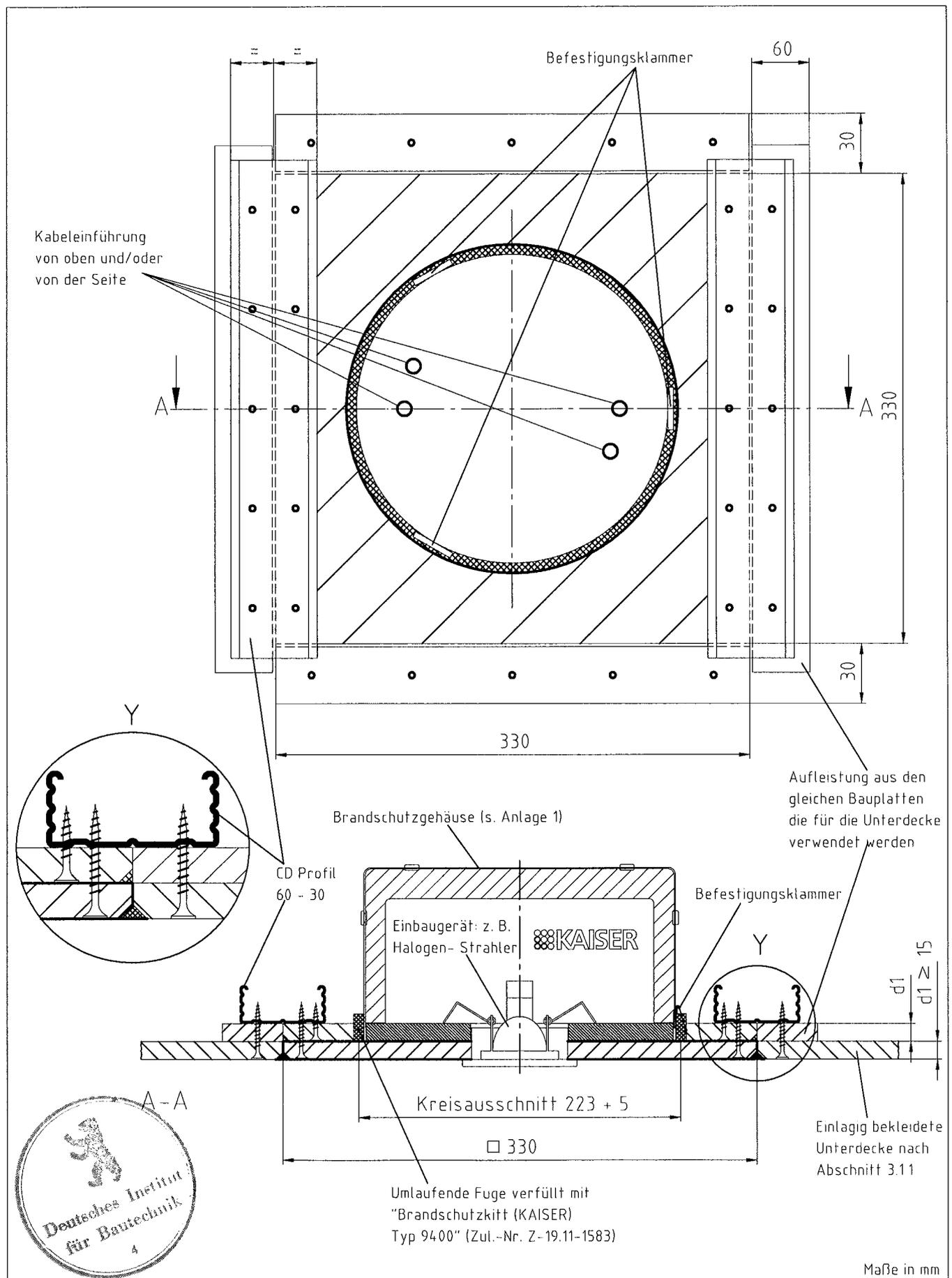
Kabelabschottung "Brandschutzgehäuse System FlamoX S 30.." der Feuerwiderstandsklasse S 30 nach DIN 4102-9
