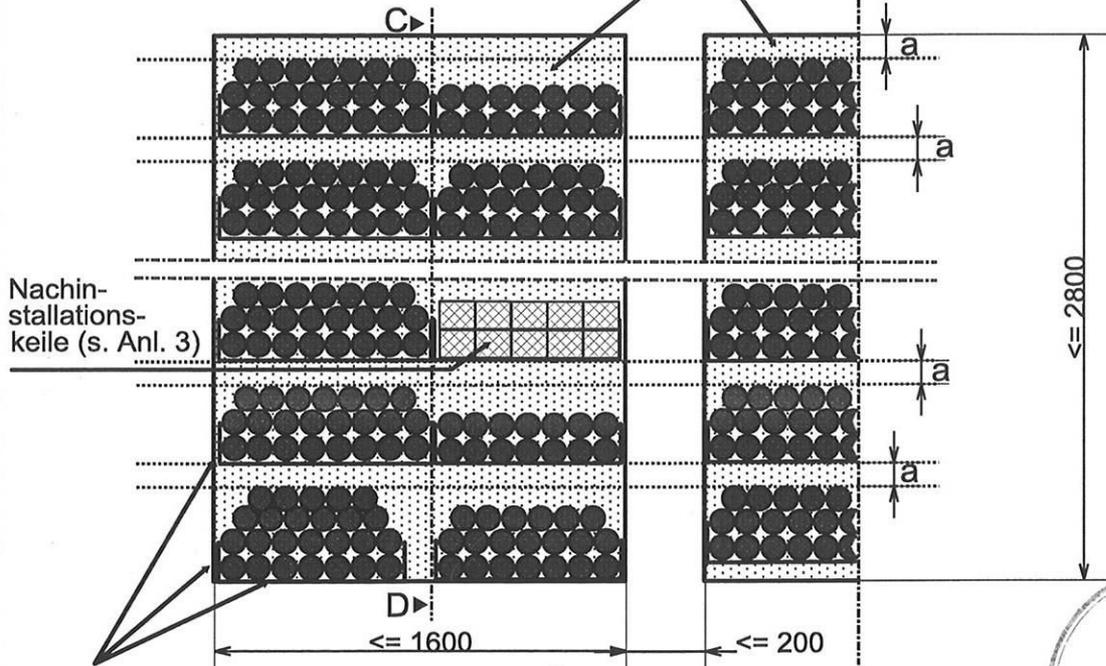
Fugen mit dämmschichtbildendem Baustoff nach Abschn. 2.1.2 gem. Abschn. 4.3.4 verfüllen
