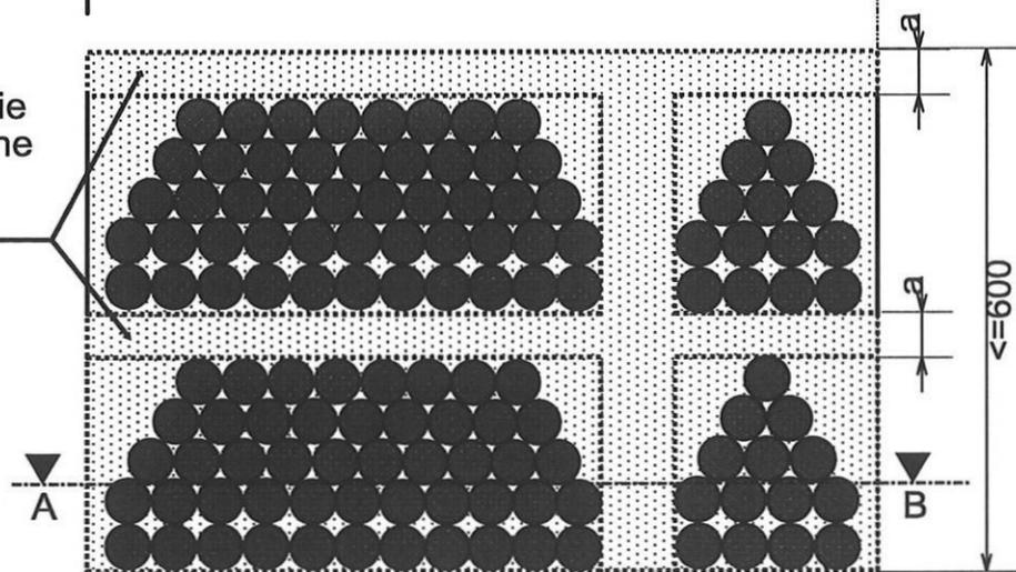
Fugen mit dämmschichtbildendem Baustoff nach Abschn. 2.1.2 gem. Abschn. 4.3.4 verfüllen
