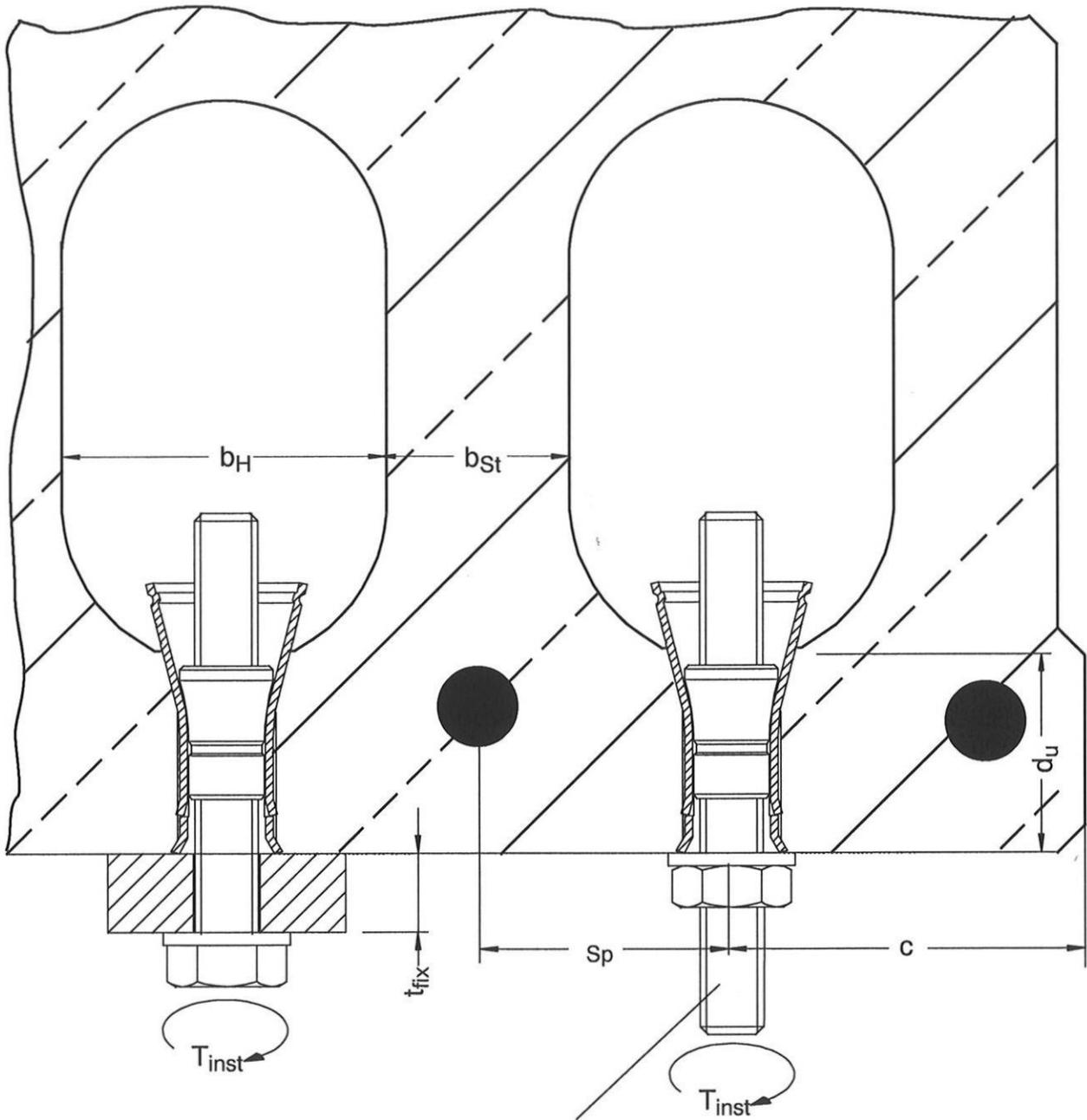
Gewinde für Anschluss z.B. einer Koppelmuffe
