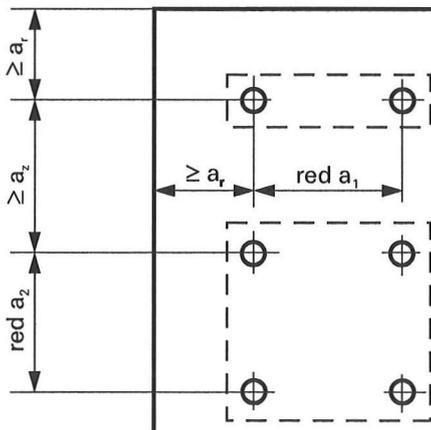
Reduzierte zulässige Lasten bei reduzierten Achsabständen je Dübel bei Dübelgruppen min  $a \leq \text{red } a \leq a$  (siehe Abschnitt 3.2.2)
