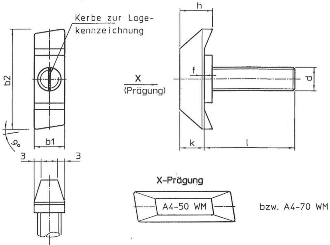
Tabelle 4: Abmessungen der Hakenkopfschrauben (mm)
