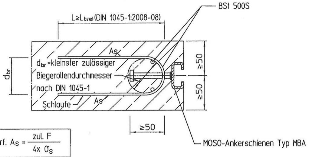
ansetzbare Stahlspannung  $\sigma_s = 80 \text{ N/mm}^2$
