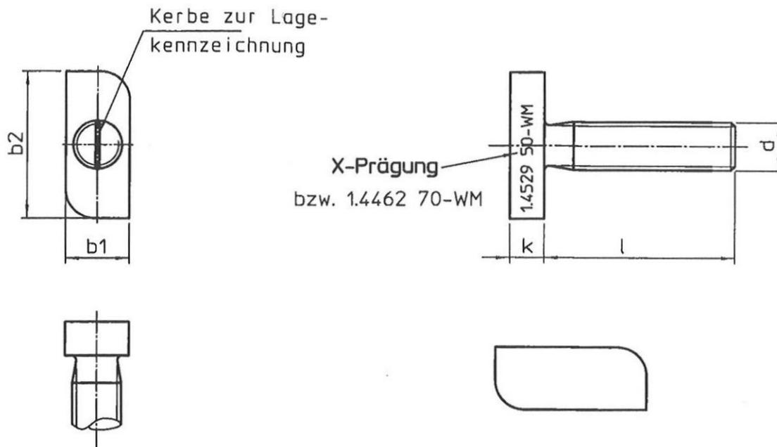
Tabelle 3: Abmessungen der Hammerkopfschrauben (mm)
