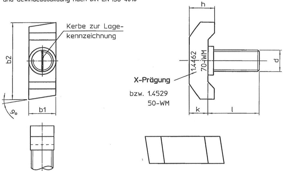
Tabelle 5: Abmessungen der Hakenkopfschrauben (mm)
