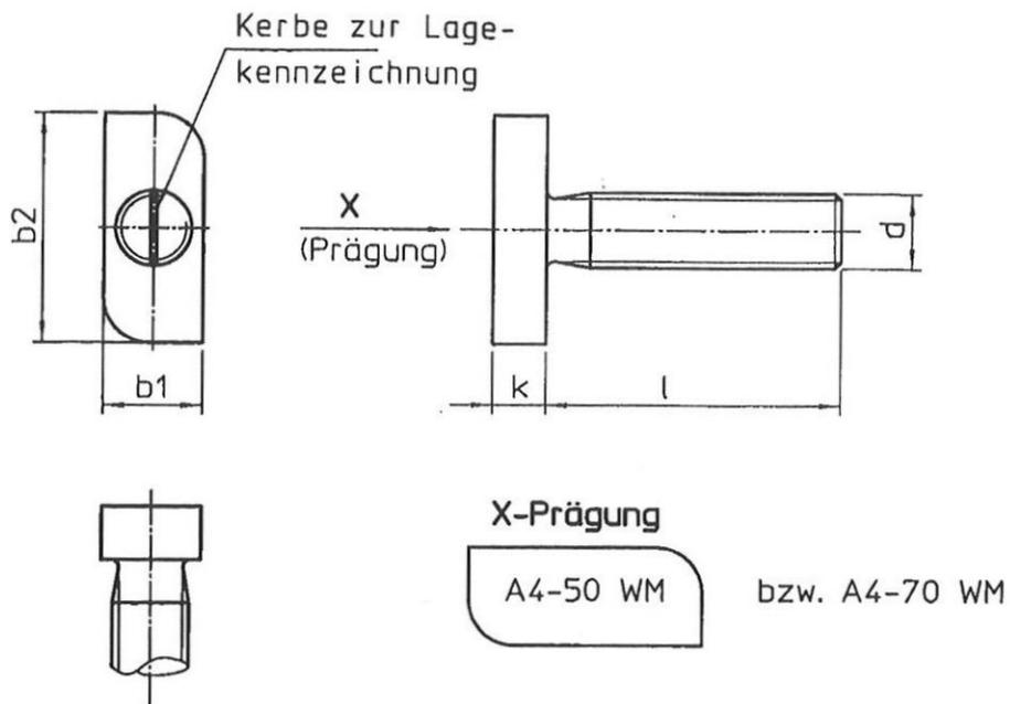
**Tabelle 2: Abmessungen der Hammerkopfschrauben (mm)**
