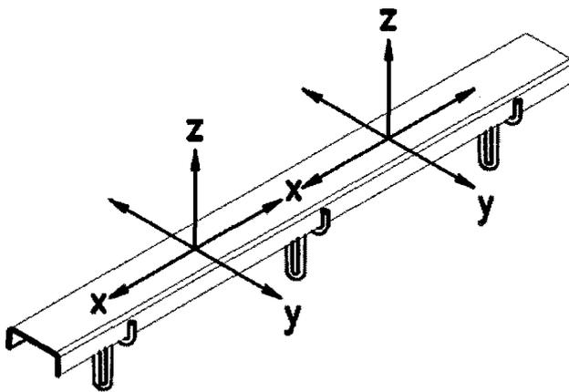
Bei gleichzeitiger Beanspruchung in allen Richtungen (Längszug + Querkzug + Zentrischer Zug) darf die Lastresultierende die zulässigen Lasten nach obiger Tabelle nicht überschreiten.
