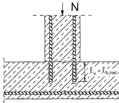
**Bild 5: Verankerung von Bewehrung zur Deckung der Zugkraftlinien.**
