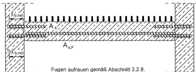
**Bild 4: Bewehrungsanschlüsse überwiegend auf Druck beanspruchter Bauteile**
