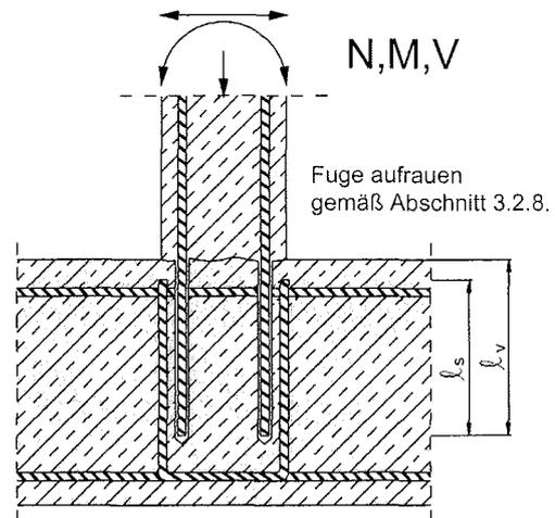
**Bild 3: Endverankerung von Platten oder Balken, bemessen als Einfeldträger**
