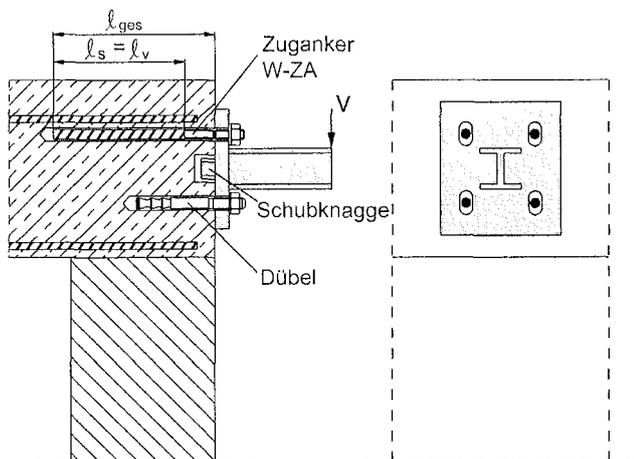
**Bild 7: Übergreifungsstoß für die Verankerung von Geländerpfosten**
