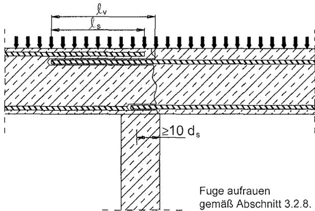
**Bild 2: Übergreifungsstoß einer biegebeanspruchten Stütze oder Wand an ein Fundament**
