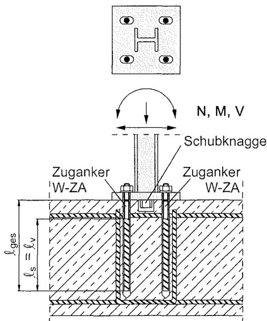
**Bild 8: Übergreifungsstoß für die Verankerung von ausragenden Bauteilen**
