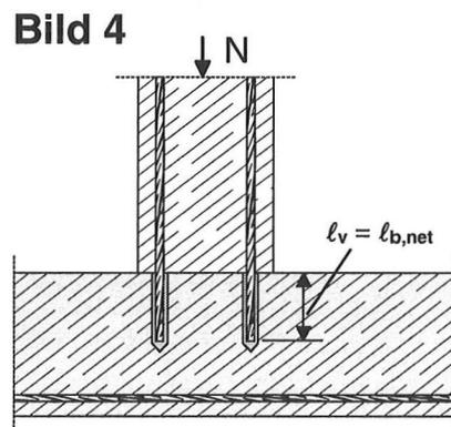
Bewehrungsanschlüsse überwiegend auf Druck beanspruchter Bauteile
