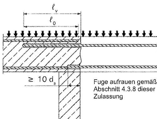
**Bild 2:** Übergreifungsstoß einer biegebeanspruchten Stütze oder Wand an ein Fundament
