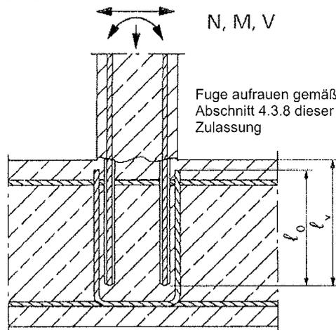
**Bild 3:** Endverankerung von Platten oder Balken
