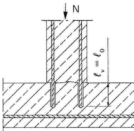
**Bild 5:** Verankerung von Bewehrung zur Deckung der Zugkraftlinien
