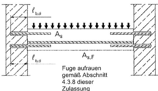
**Bild 4:** Bewehrungsanschlüsse überwiegend auf Druck beanspruchter Bauteile
