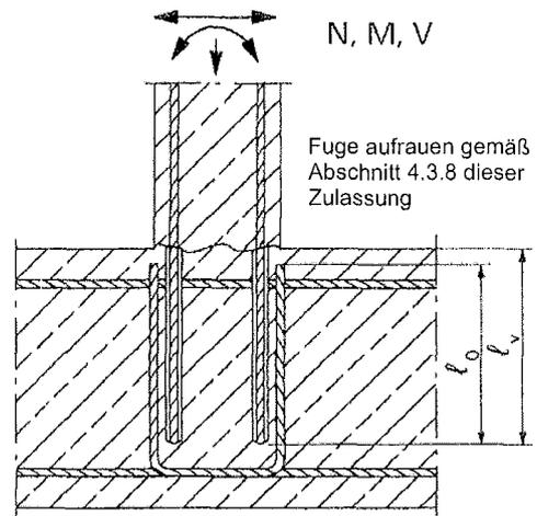
**Bild 3:** Endverankerung von Platten oder Balken
