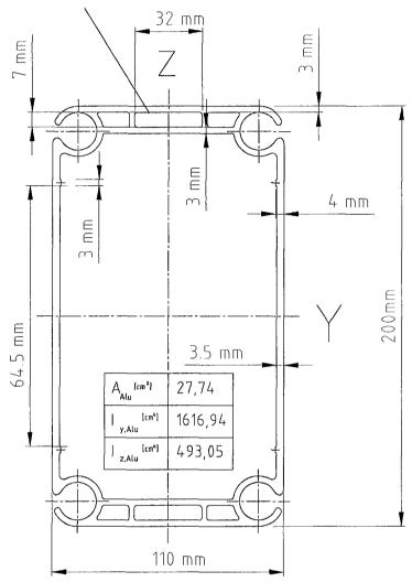
Detaillierte Angaben zur Querschnittsgeometrie sind beim DIBt hinterlegt.
