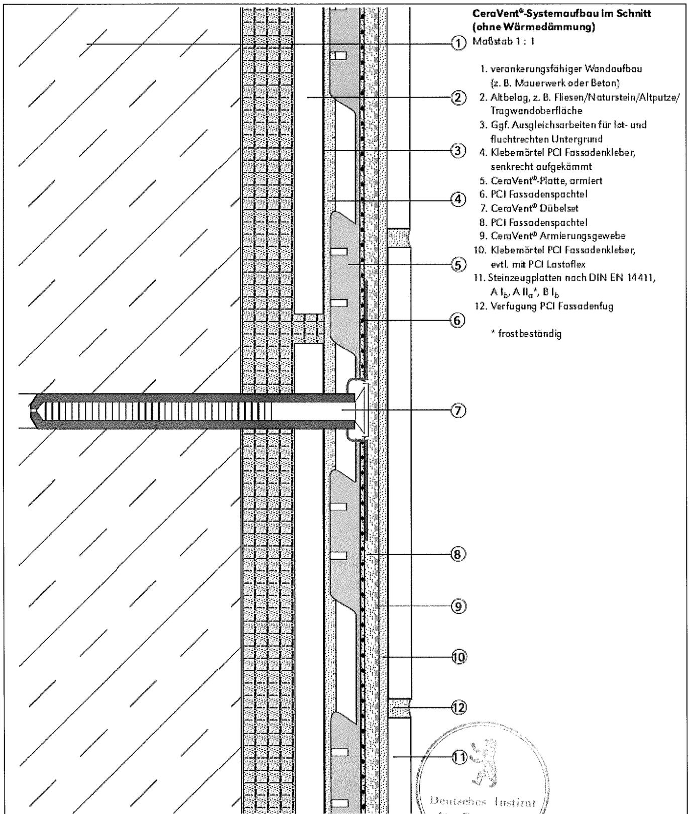
Alternativ darf das CeraVent System auf vormontierten Dämmstoffplatten aus EPS oder auf vorhandenen Wärmedämmverbundsystemen (WDVS) gemäß Abschnitt 1.2 aufgebracht werden. Dabei sind die Dübel durch die Dämmplatten bzw. das WDVS hindurch in den tragenden Untergrund (Beton oder Mauerwerk) zu verankern.
