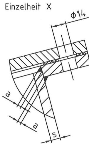
wahlweise : a ) Losdeckel mit Durchgangsschrauben M 12
