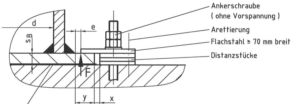
PE - Zwischenplatte  $\geq 2$  mm
