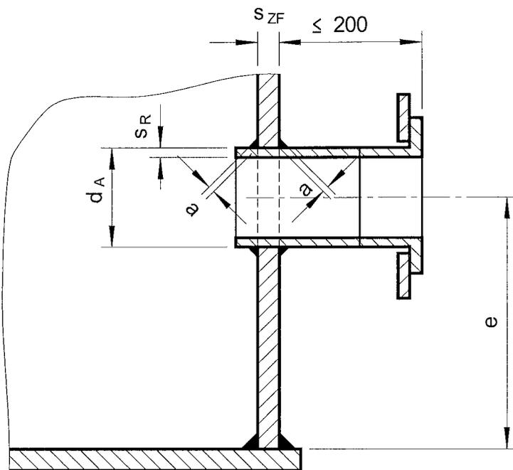
$$a \geq 0,7 \cdot \min(s_{ZF}, s_R) \quad (\text{WE, WZ})$$
