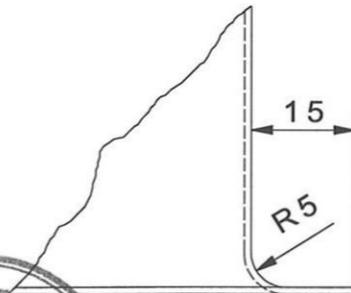
Feuerverzinktes Stahlblech DX51D+Z275NA
