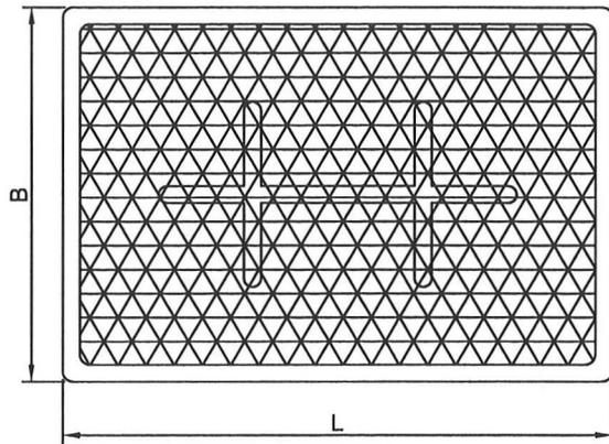
Material der Sicherheitswanne: PE-LLD rotationsgesintert
