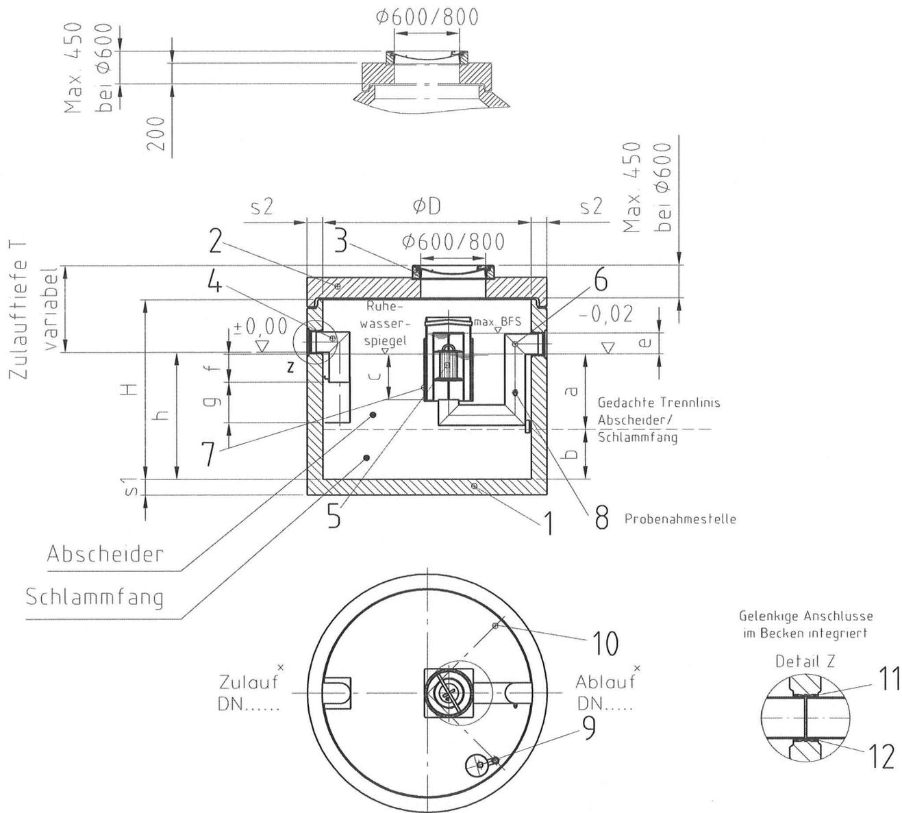
x Anschlüsse nach DIN 19534/19537 bzw. DIN EN 877 DN 150 - außen -  $\phi 160 \pm 2$
