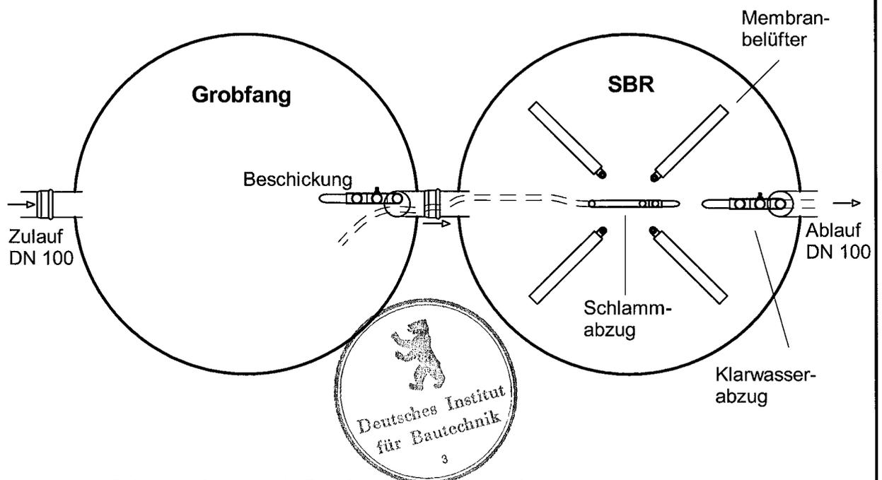
Klarwasser- und Schlammabzug sowie Beschickung mit Drucklufthebern.
