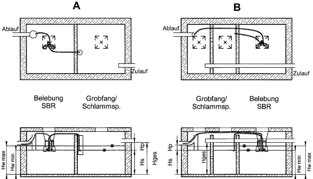
Grobfang/Schlamm-speicher kann ein- und mehrkammrig ausgebildet sein. Alle Kammern können als separate Behälter ausgeführt sein.
