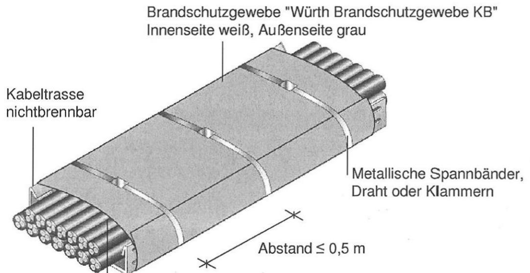
Bei Abstand zwischen dem Brandschutzgewebe "Würth Brandschutzgewebe KB" und der Kabeloberfläche  $\leq 30$  mm und Verlegung um mehr als  $45^\circ$  aus der Horizontalen oder vertikal ist Maßname "Würth S" nach Anlage 4 erforderlich
