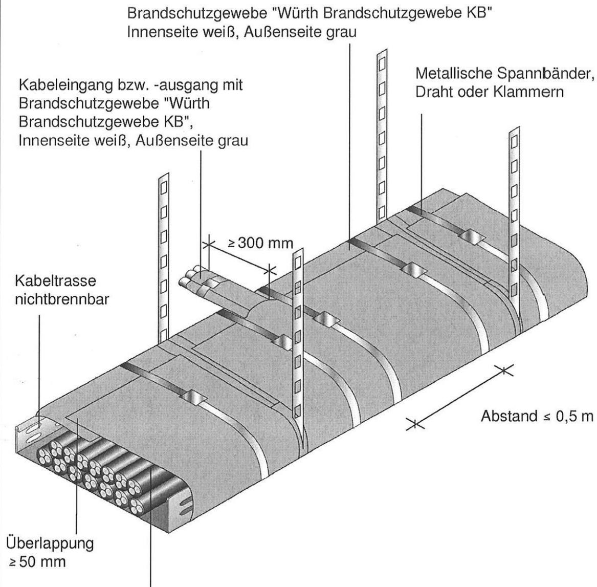
Abstand zwischen dem Brandschutzgewebe "Würth Brandschutzgewebe KB" und der Kabeloberfläche  $\leq 30$  mm und Verlegung um mehr als  $45^\circ$  aus der Horizontalen oder vertikal - s. Abschnitt 4.1.5 und Anlage 4
