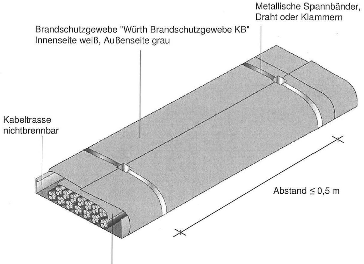
Zwischenlage als Abdeckung der oberen Kabellage :
