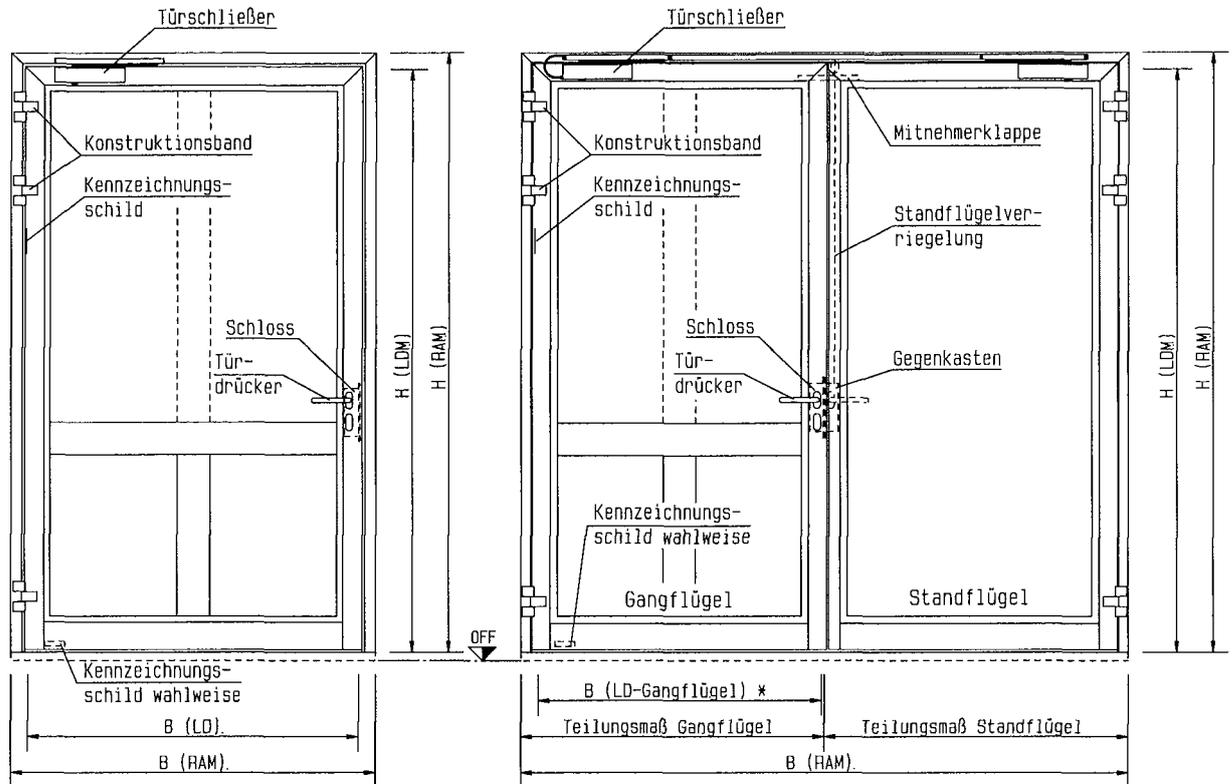
\* Bei Verwendung eines Falztreibriegels steht der LD-Gangflügel nur als Rettungsweg zur Verfügung. Dieses Maß verringert sich bei einem Öffnungswinkel von nur 90 Grad.
