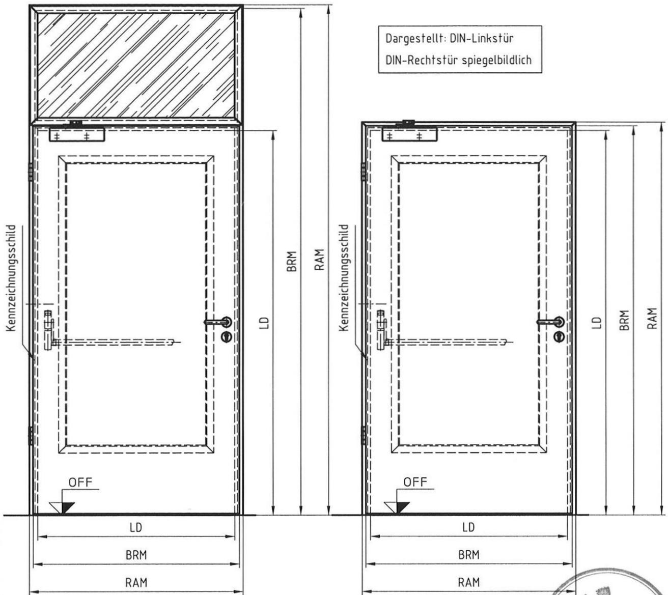
T30-1-RS-FSA immer mit absenkbarer Bodendichtung oder mit 4-seitig umlaufender Zargendichtung ausführen. Den Wandanschluss der Zarge immer beidseitig versiegeln!
