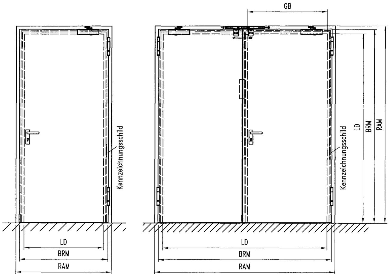
T30-1-RS-FSA und T30-2-RS-FSA immer mit absenkbarer Bodendichtung oder umlaufender Flügeldichtung ausführen. Wandanschluss immer mind. auf Öffnungsseite (Bandseite) des FSA versiegeln!
